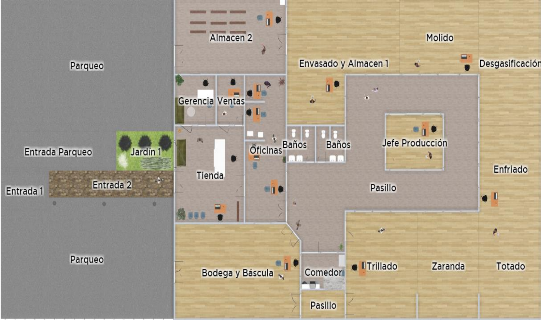
Figura 6 Plano de distribución de la planta de torrefacción de café en 2D
